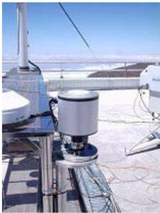
**Figura 3.1.-** Radiómetro Multicanal de Ancho de Banda Moderada (*NILU-UV*) en la estación de Izaña.
