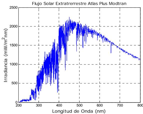
**Figura 5.1.-** Espectro solar extraterrestre “Atlas Plus Modtran”.
