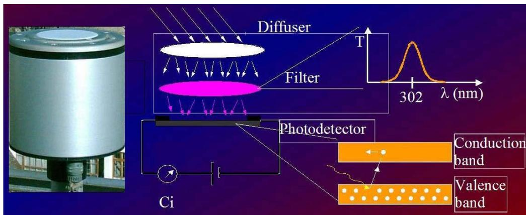
**Figura 3.3.-** Esquema de medida del radiómetro *NILU-UV* [Norsang, 2004].
