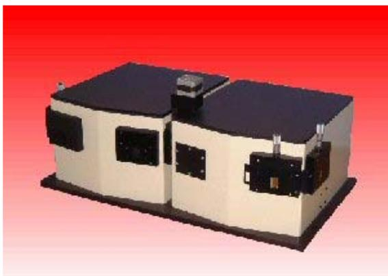
**Figura 3.4.-** Espectrorradiómetro *Bentham* DMT 300.
