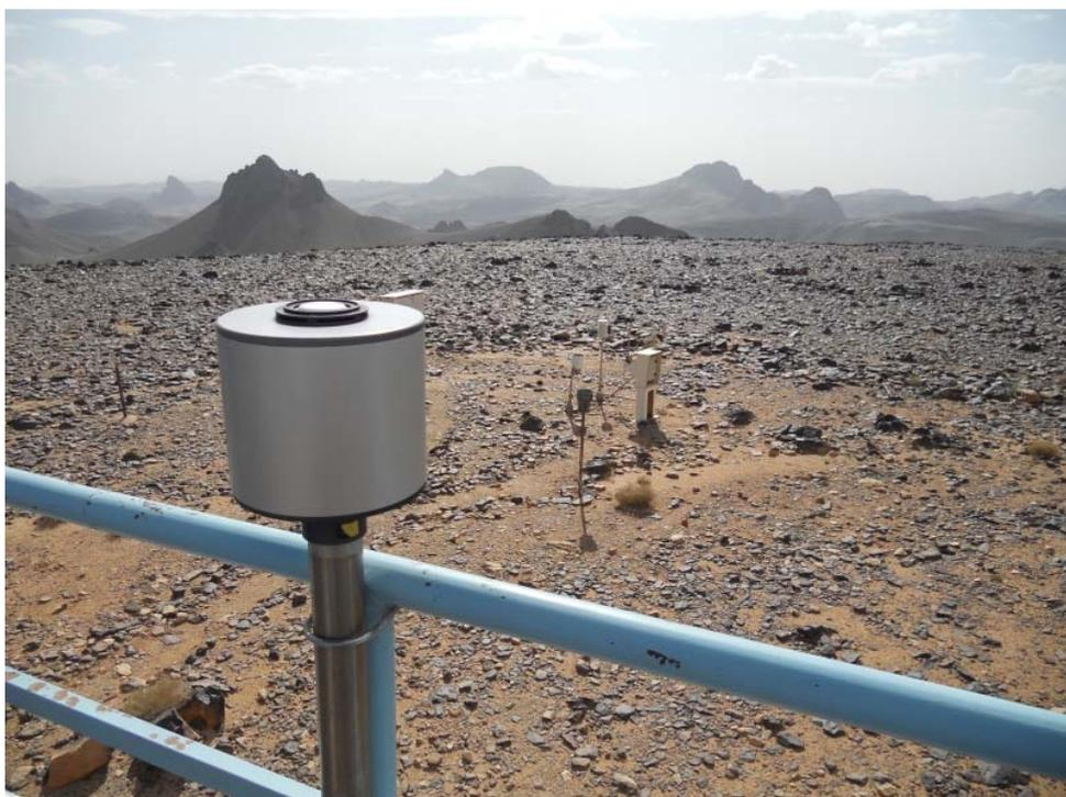
*Photo 6: Le radiomètre NILU-UV Multifilter-6 avec les montagnes de l'Ahaggar (Hoggar) à l'horizon.*
