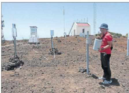
Recogida. Un meteorólogo recoge datos del pluviómetro de niebla.
