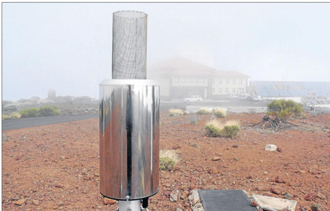
En el jardín. El pluviómetro Hellmann, adaptado para recoger agua de niebla con una malla milimétrica, está en el jardín meteorológico de Izaña.
