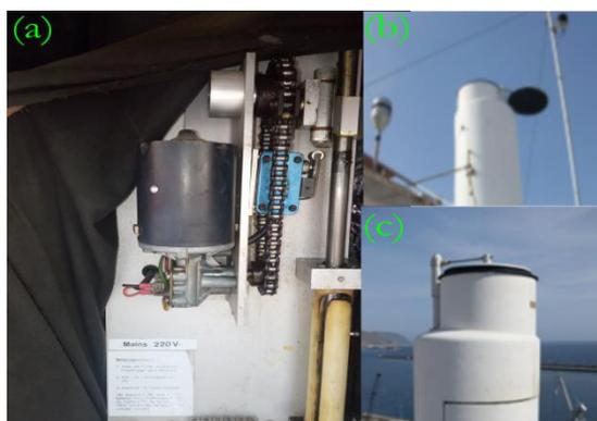
Figura 3.6. (a) Imagen del motor que permite abrir o cerrar la cúpula del MPL-3. (b) Imagen de la cúpula abierta. (c) Imagen de la cúpula cerrada.
