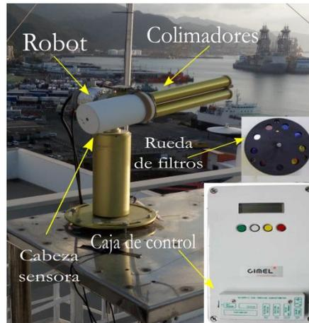
Figura 3.15. Componentes principales de un fotómetro Cimel-CE.
